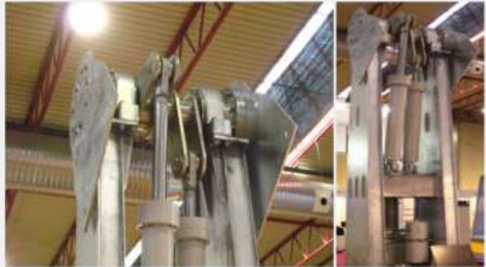
Fig. 6 Cilindros hidráulicos y sistema biela-manivela
